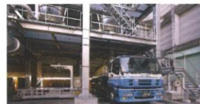
⑧ 炭化物搬送・貯留設備 Carbide transportation/storage facilities 下水汚泥炭化燃料(炭化物)は冷却コンベヤにて冷却後、冷却器にて十分に間接冷却した後ホッパにて貯留します。 Carbonized sewage sludge fuel (carbide) is cooled in the cooling conveyor, then stored to the storage hopper.
