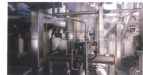
④ 炭化物回収器 Carbide recovery system 粉体の炭化物と熱分解ガスは遠心力により分離されて、回収器の底部から炭化物が回収されます。 The carbide powder is separated from the pyrolysis gas by centrifugal force, and the carbide recovered from the base of the unit.
