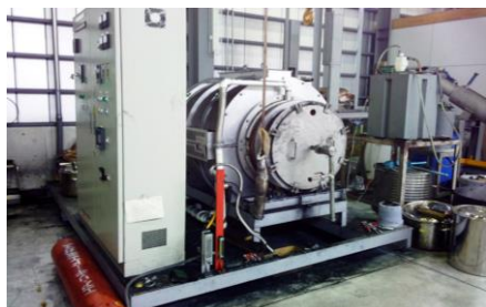
水蒸気賦活炉(ロータリーキルン炉)
